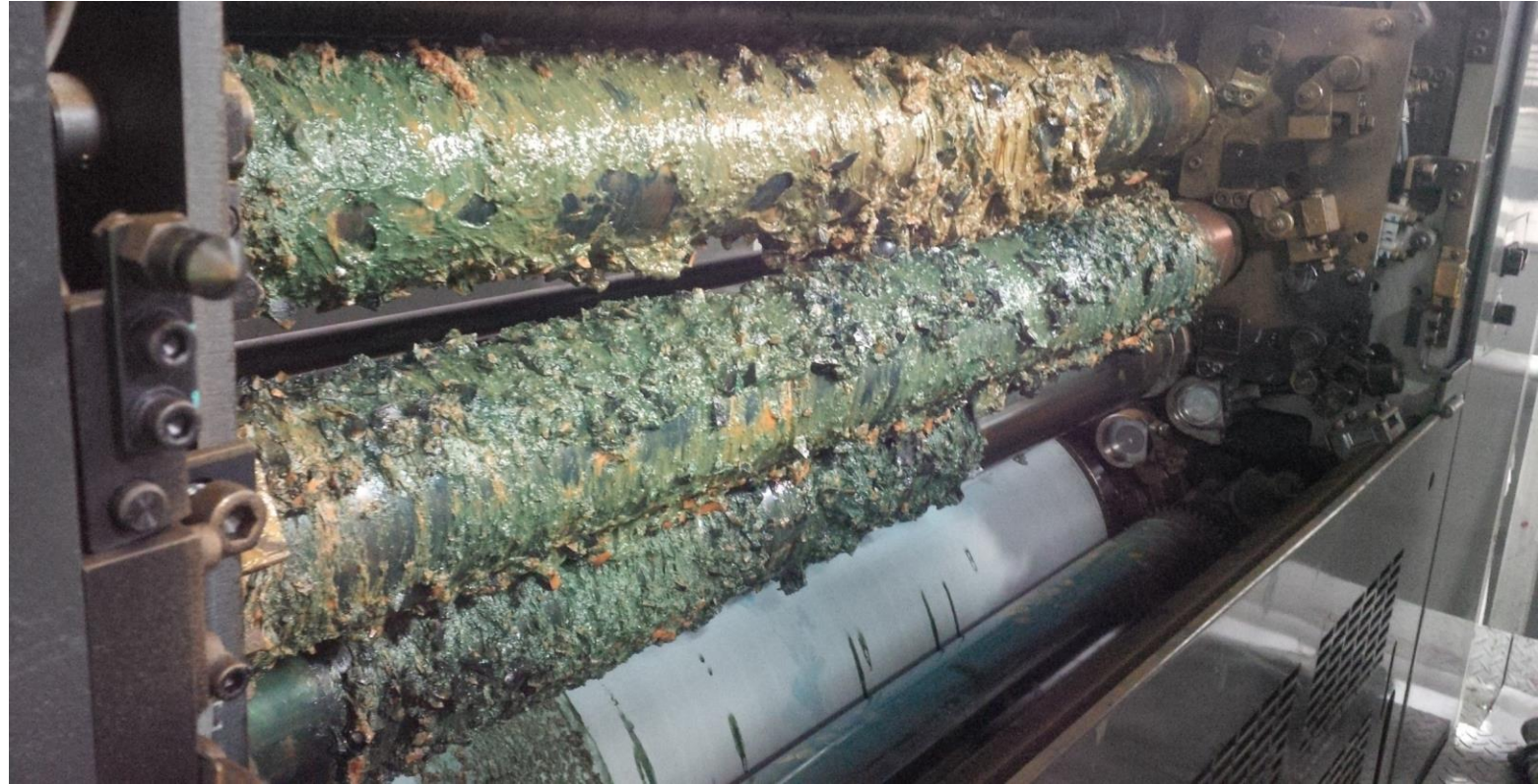
Japanischer Polyurethanwerkstoff für Kombibetrieb nach hydrolytischer Zersetzung
