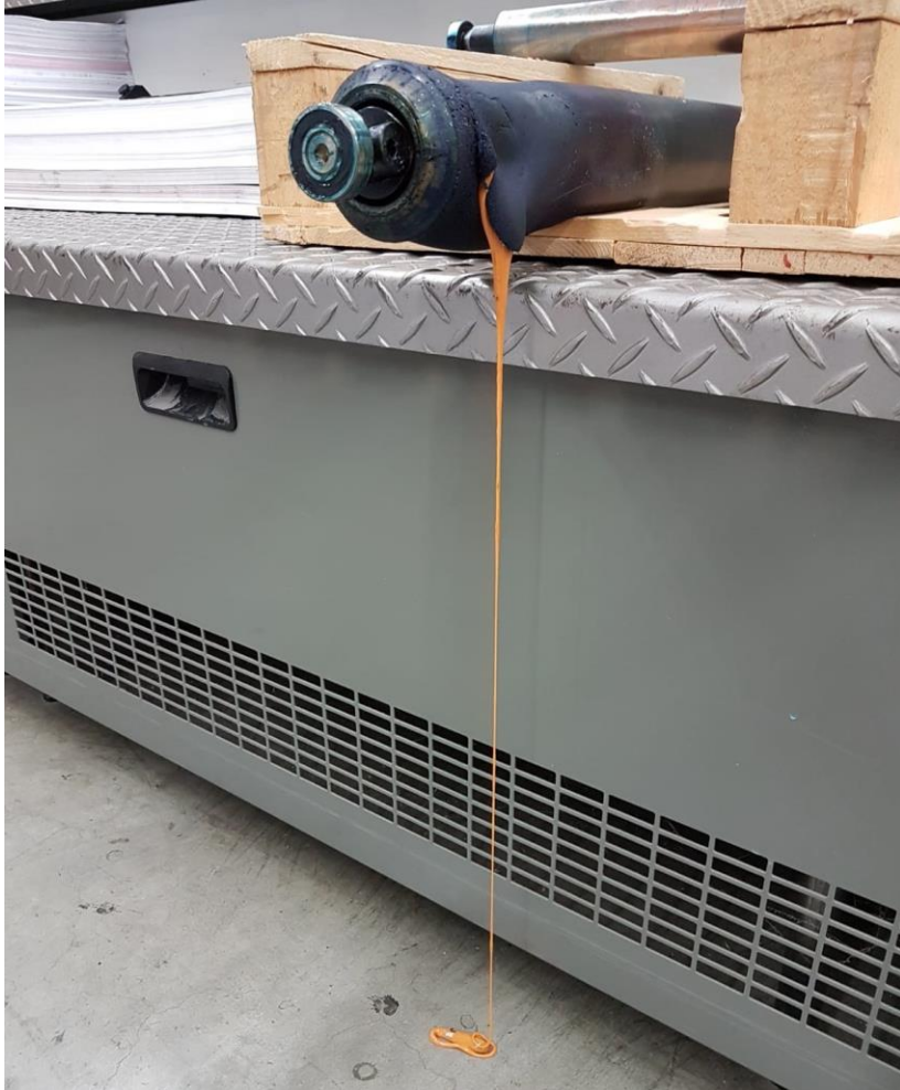
Japanischer Polyurethanwerkstoff für Kombibetrieb nach hydrolytischer Zersetzung
